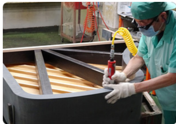
画像参照：木をけずって形を整えているようす（河合楽器製作所公式HPより）
